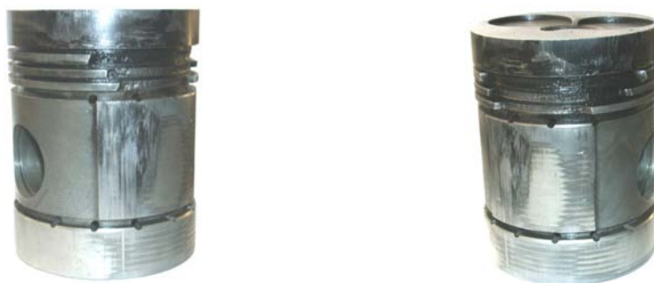
Rys. 1. Uszkodzenia tłoka spowodowane spalaniem stukowym [1] Fig. 1. Piston damage caused by knock combustion [1]
